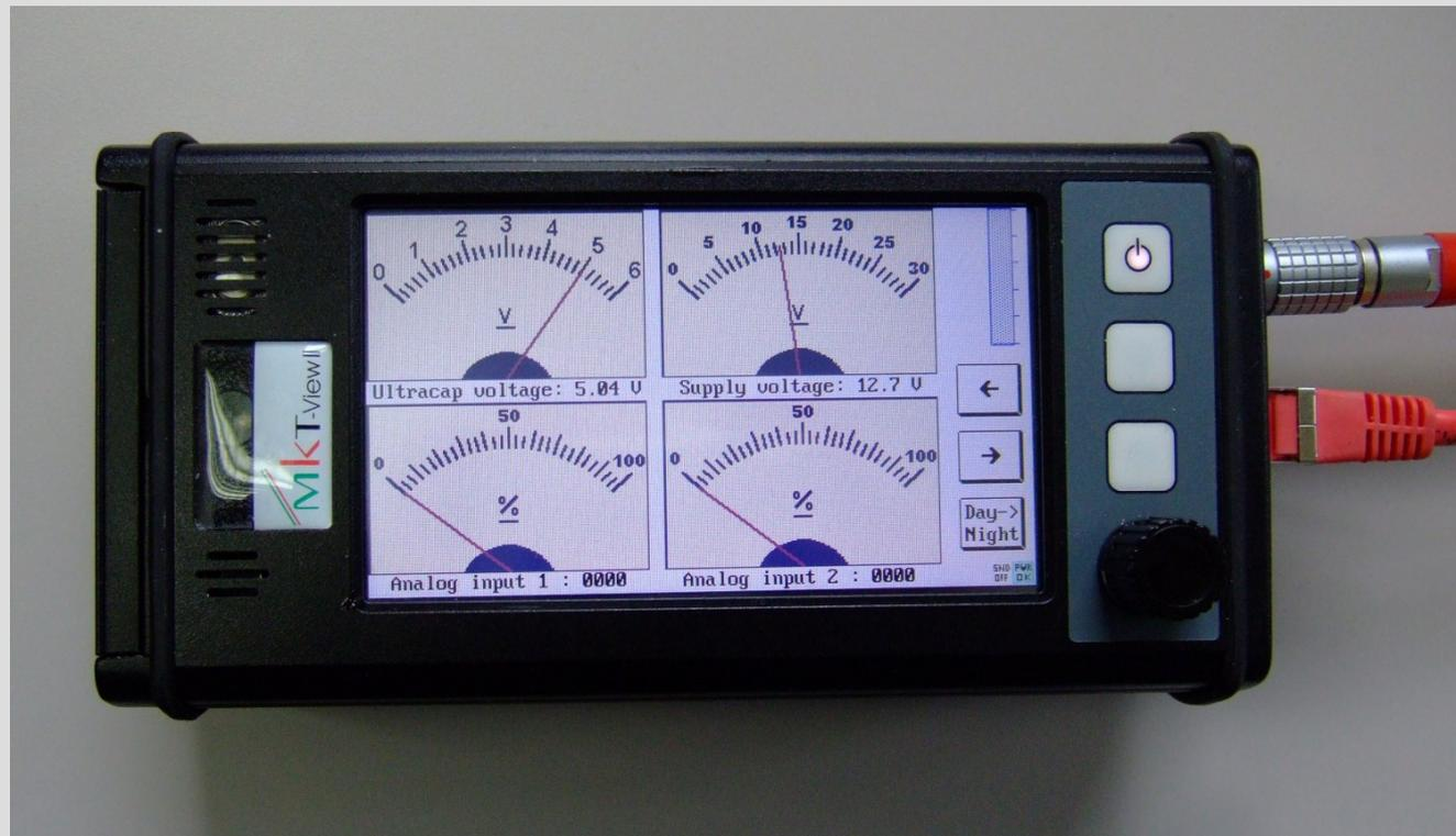
Zweite Generation der MKT-View Familie: 32-Bit-CPU, 72..96 MHz, 4.3" TFT mit Touch, 480 \* 272 Pixel, Ethernet, SD-Karte.
