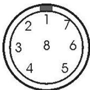
**Abbildung 5:** Pinbelegung der Lemo-Gerätebuchsen ECG.1B.314 (Geräteansicht)
