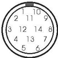
**Abbildung 3:** Pinbelegung der Lemo-Gerätebuchse ECG.1B.314 (Geräteansicht)
