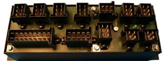
Der robuste Aufbau mit Messerleisten ermöglicht eine kompakte Verdrahtung und den flexiblen Einbau.
