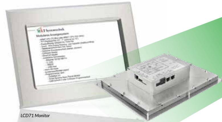
Rückseite LCD71 Monitor mit CODESYS 3.5 Modul
