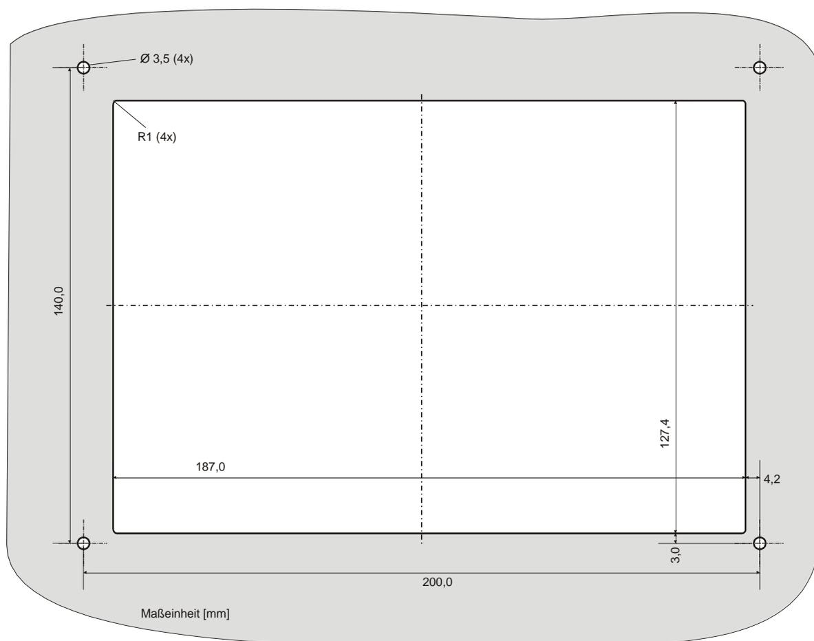
Abbildung 10: Maßzeichnung zum Frontplatteneinbau
