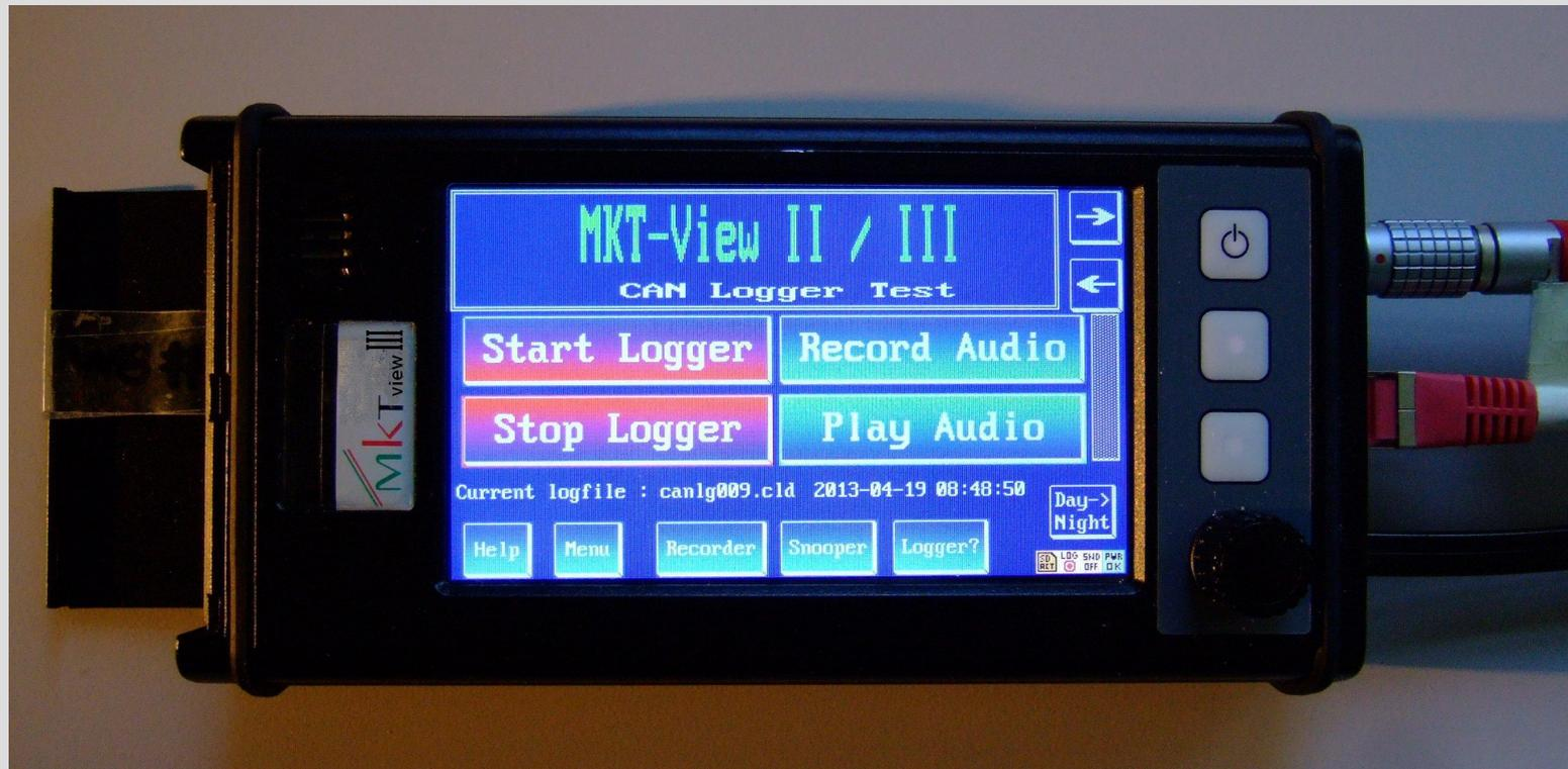
Zweite Generation der MKT-View Familie: 32-Bit-CPU, 72..96 MHz, 4.3" TFT mit Touch, 480 \* 272 Pixel, Ethernet, Web Server, Speicherung der geloggten Daten auf SD / SDHC-Speicherkarte.
