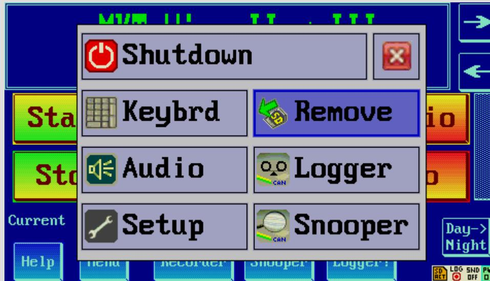
(beim MKT-View II / III wird das oben gezeigte 'Shutdown-Fenster' per Touchscreen-Geste, oder mit der 'Power-Taste' / F1 geöffnet )
